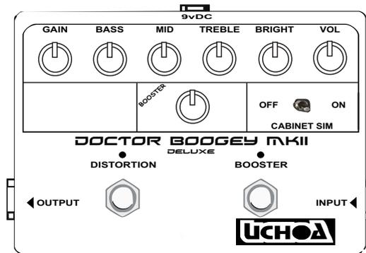
O UCHOA DOCTOR BOOGEY MKII, é uma unidade de distorção projetada para simular analógicamente o som de amplificadores valvulados.
