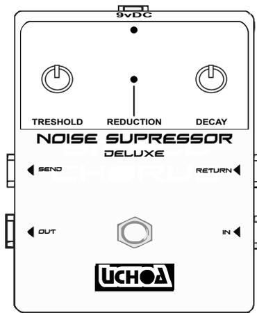
O UCHOA NOISE SUPPRESSOR, é um avançado supressor de ruídos, que pode detectar o sinal do instrumento separadamente do ruído e tornar possível a redução do ruído da cadeia de pedais ligada nas conexões SEND E RETURN, sem degradar a qualidade do audio original.
